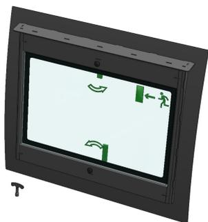
Pannello Hammerglass IR Green per sostituire il vetro originale. Hammerglass IR assorbirà radiazioni infrarossi del sole e ridurrà il calore solare in entrata del 50%. Da incollare come il parabrezza originale. **IMPORTANTE!** Utilizzare colla elastica! **NON** utilizzare la normale colla per vetri auto.
