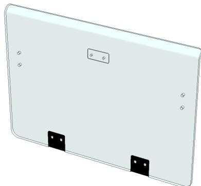
Pannello Hammerglass IR Green per sostituire il vetro originale. Hammerglass IR assorbirà radiazioni infrarossi del sole e ridurrà il calore solare in entrata del 50%. Da incollare come il parabrezza originale. **IMPORTANTE!** Utilizzare colla elastica! **NON** utilizzare la normale colla per vetri auto.
