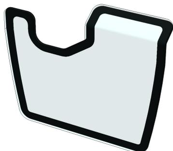
Pannello Hammerglass IR Green per sostituire il vetro originale. Hammerglass IR assorbirà radiazioni infrarossi del sole e ridurrà il calore solare in entrata del 50%. Da incollare come il parabrezza originale. **IMPORTANTE!** Utilizzare colla elastica! **NON** utilizzare la normale colla per vetri auto.
