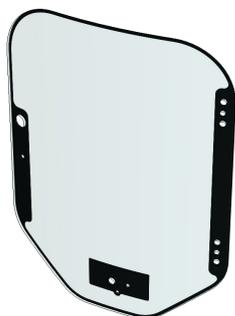
Pannello Hammerglass per sostituire il vetro originale. Con pellicola protettiva ScreenSaver applicata in fabbrica. Da incollare come il parabrezza originale. **IMPORTANTE!** Utilizzare colla elastica! **NON** utilizzare la normale colla per vetri auto. La pellicola può essere sostituita quando danneggiata o rigata.
