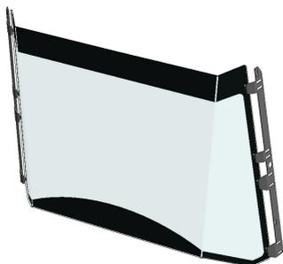
Pannello Hammerglass per sostituire il vetro originale. Con pellicola protettiva ScreenSaver applicata in fabbrica. Da incollare come il parabrezza originale. **IMPORTANTE!** Utilizzare colla elastica! **NON** utilizzare la normale colla per vetri auto. La pellicola può essere sostituita quando danneggiata o rigata.
