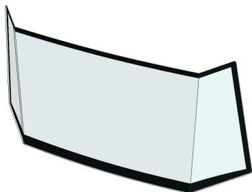
Pannello Hammerglass per sostituire il vetro originale. Con pellicola protettiva ScreenSaver applicata in fabbrica. Da incollare come il parabrezza originale. **IMPORTANTE!** Utilizzare colla elastica! **NON** utilizzare la normale colla per vetri auto. La pellicola può essere sostituita quando danneggiata o rigata.
