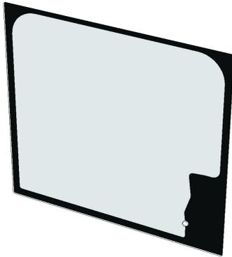
Pannello Hammerglass per sostituire il vetro originale. Con pellicola protettiva ScreenSaver applicata in fabbrica. Da incollare come il parabrezza originale. **IMPORTANTE!** Utilizzare colla elastica! **NON** utilizzare la normale colla per vetri auto. La pellicola può essere sostituita quando danneggiata o rigata.
