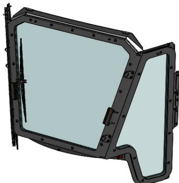
RABS Hammerglass. Contiene: Parabrezza RABS da 12 mm in telaio d'acciaio, schermo protettivo ScreenSaver da 4 mm, contro-telaio di montaggio per schermo ScreenSaver. Soluzione a prova di esplosione. Il schermo ScreenSaver brevettato protegge lo schermo più robusto da 12 mm nel telaio RABS, ed è un prodotto di pura usura.
